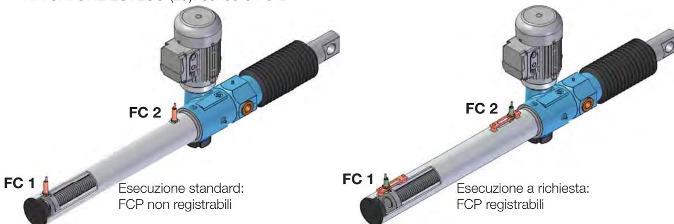
In esecuzione standard, la posizione dei sensori lungo il tubo non è regolabile e non è fissata angularmente. A richiesta può essere fornita esecuzione con posizione angolare a scelta del cliente.
