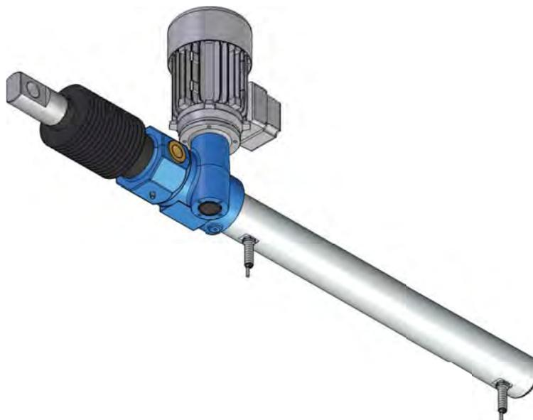
Fissaggio del corpo tramite perni o boccole in bronzo
